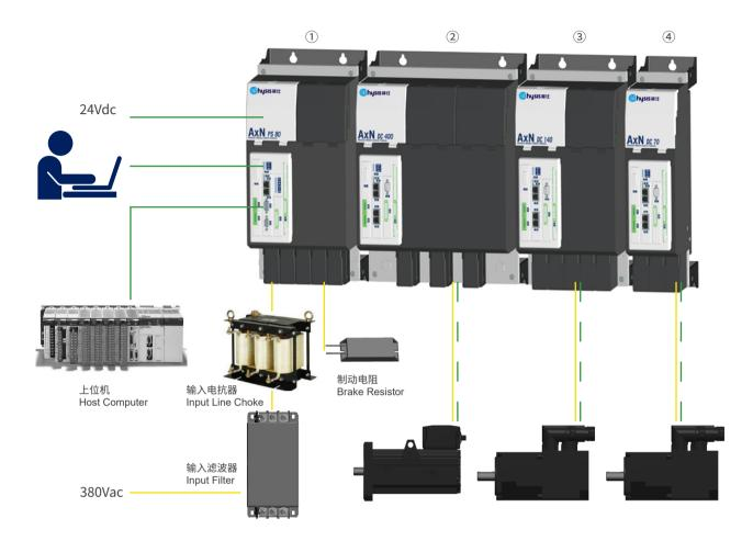
① 整流单元: AxN-PS80 Rectifier Unit: AxN-PS80 ② 逆变单元: AxN-DC400 Inverter Unit: AxN-DC400 ③ 逆变单元: AxN-DC140 Inverter Unit: AxN-DC140 ④ 逆变单元: AxN-DC70 Inverter Unit: AxN-DC70
